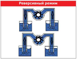
Может работать в 2-х направлениях. Это позволяет вернуть лишнюю жидкость без ручного вмешательства. Также, легкое опорожнение труб осуществляется при завершении перекачки жидкости.
