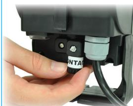
**4** Открутите гайку воздуховыпускного клапана, раствор начнет опускаться через трубку. Как только это закончится, затяните гайку.
